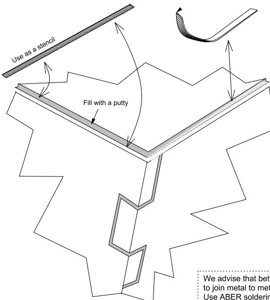
We advise that better method to join metal to metal is soldering. Use ABER soldering solution AF20 (doradzamy łączenie części metalowych za pomocą lutownia. Zastosuj nasz topnik AF20).
